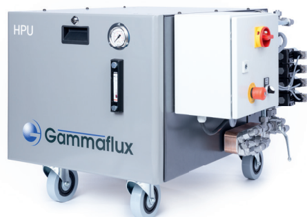
Alleinstehende mobile HPU (Hydraulikeinheit)
